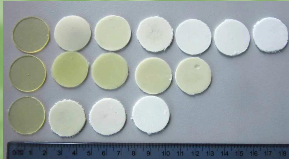
Fotod liimvaik-komposiidi termiliste omaduste määramiseks kasutatud katsekehadest
