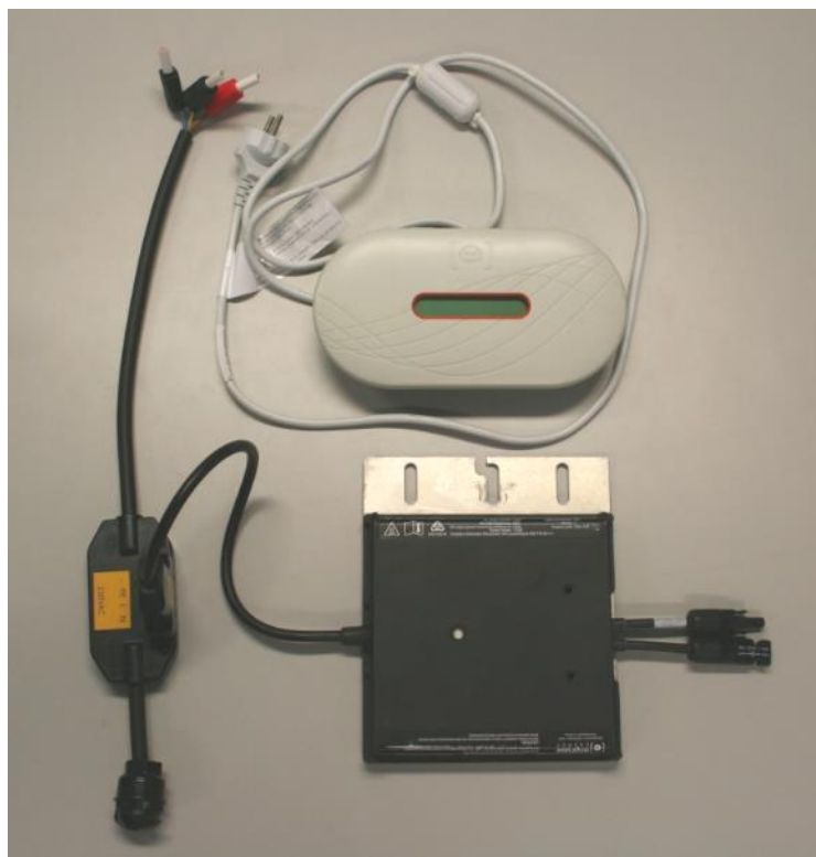
MICROINVERTER ENPHASE M250
